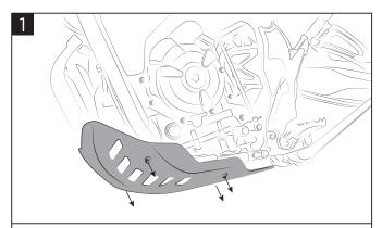
Remove the original skid plate by untightening the four screws. Rimuovere il sottomotore originale togliendo le 4 viti.
