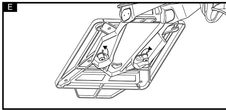
Ruotare le due chiusure di bloccaggio sino ad oltrepassare i fermi di sicurezza.
